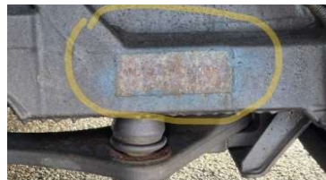
Attēls Nr.15. Sarūsējusi VIN numura plāksne Preiļu novada pašvaldības autobusam
