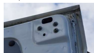
Attēls Nr.13. Dienvidkurzemes novada pašvaldības mikroautobusa durvis ar rūsu un trūkstošu skrūvi
